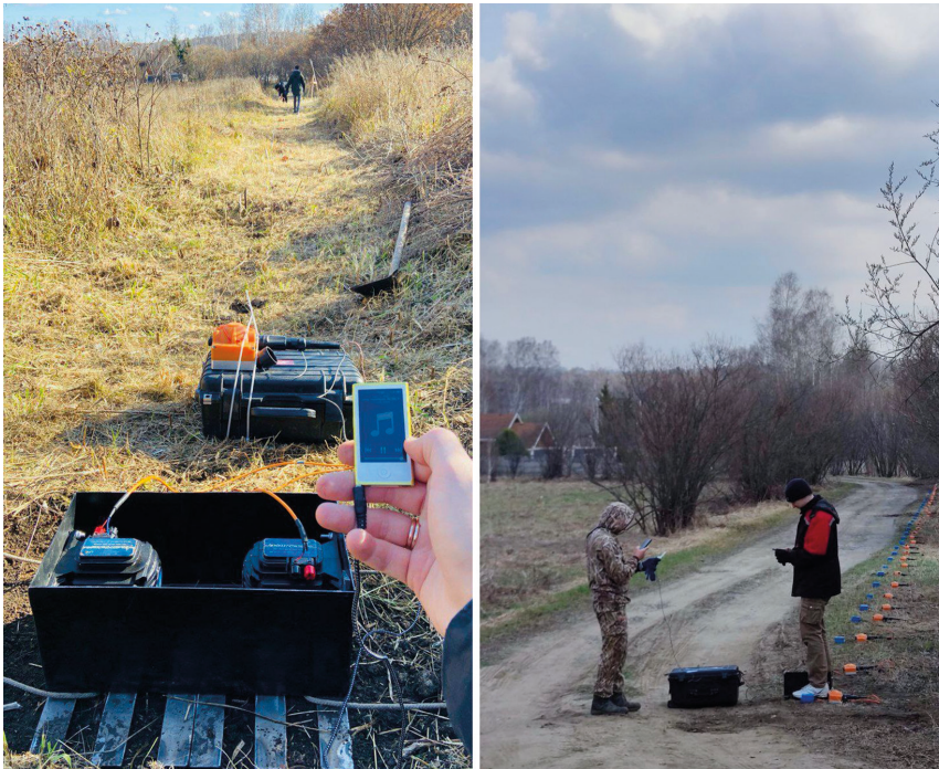
Рис. 3. Фотографии, демонстрирующие процесс работы с вибрационной установкой в полевых условиях. Слева — вибрационная установка в сборе с блоком синхронизации вспомогательных каналов (БСВК) сейсмостанции SCOUT. Справа — процесс работы на профиле
