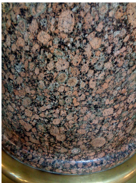
Рис. 2. Выборгит в колонне внутри Казанского собора (а) и питерлит в тротуаре Аничкова моста (б)
